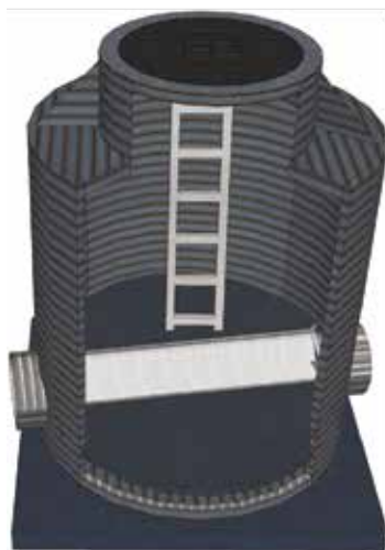
Рисунок 1. Типовой сварной канализационный колодец FD с шахтой FD SVT
